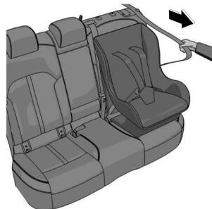
7. Empuje el sistema de seguridad para niños firmemente en el asiento del vehículo. Asegúrese que el cinturón lo apriete bien. Podrá oír ruidos provenientes del retractor al funcionar si el sistema se encuentra en el modo de bloqueo automático. Si el cinturón no sostiene el asiento bien seguro, repita este procedimiento.
