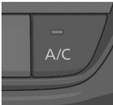
La función de enfriamiento/deshumidificación se activa y desactiva cada vez que se presiona el interruptor. El indicador se enciende mientras la función está en funcionamiento.
