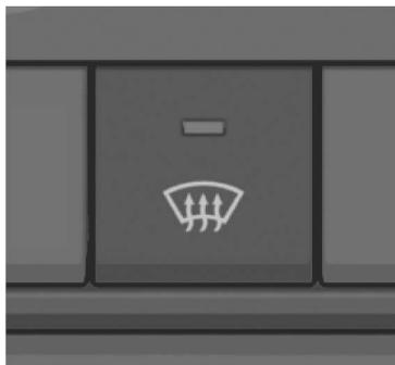
Activa (indicador encendido) y desactiva (indicador apagado) el desempañador del parabrisas. Utilícelo para descongelar/desempañar el parabrisas y las ventanillas laterales. El modo de aire frío (☸) se selecciona automáticamente y el aire acondicionado se activa automáticamente cuando el desempañador del parabrisas está en funcionamiento.
