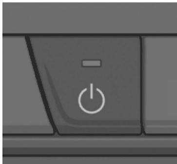
Enciende y apaga el sistema de aire acondicionado. El indicador se enciende mientras la función está en funcionamiento.
