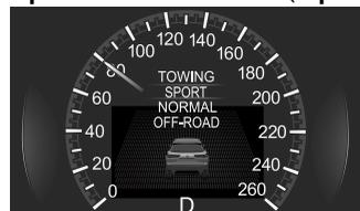
Tras ajustar el modo de conducción, la pantalla del tablero de instrumentos cambiará.
