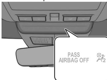
Si los sensores de peso del asiento del acompañante están bien, el indicador se enciende cuando la alimentación del vehículo se coloca en la posición ON. La luz se apaga después de algunos segundos. Luego, el indicador se enciende o se apaga en las siguientes condiciones:
