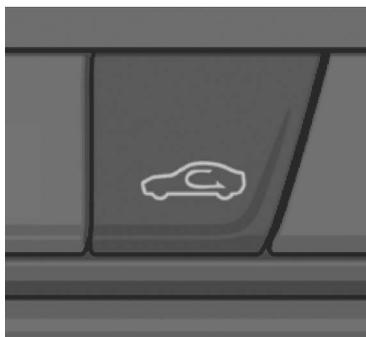
El modo cambia entre el modo de recirculación y el modo de aire frío cada vez que se presiona el interruptor.
