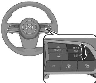
Al ajustar la velocidad, la velocidad ajustada se muestra en la pantalla. Además, la indicación en espera del ISA (blanca) LIM cambia a la indicación de ajuste del ISA (verde) LIM.
