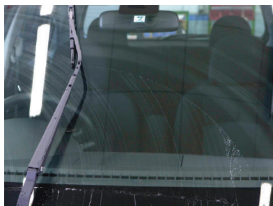
Partes sin limpiar debido a limpiaparabrisas deteriorados
